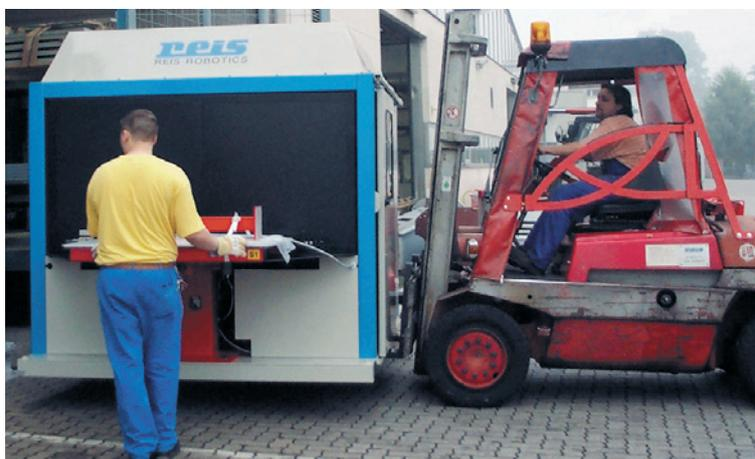
▲ Célula móvel com empilhadeira de 3 t. Dimensões compatíveis para transporte com caminhão ou em contêiner.
