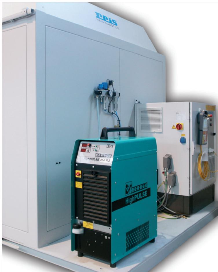
▲ Comando do robô e fonte de soldagem montados no monobloco em área protegida na parte posterior. Conexão central para mídia.
